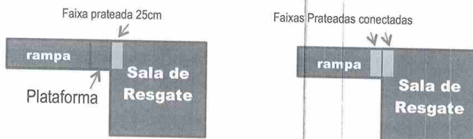
Figura 7 – Faixa prateada na entrada da sala de resgate com e sem plataforma.
