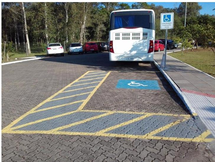
Figura 2 – Rampa para acesso a deficientes físicos.
